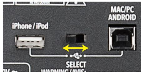
Spider V 背面のコネクタとアプリを使用するデバイスで USB ケーブルで接続し、スイッチをご使用になる端子の方向に入れてください。
